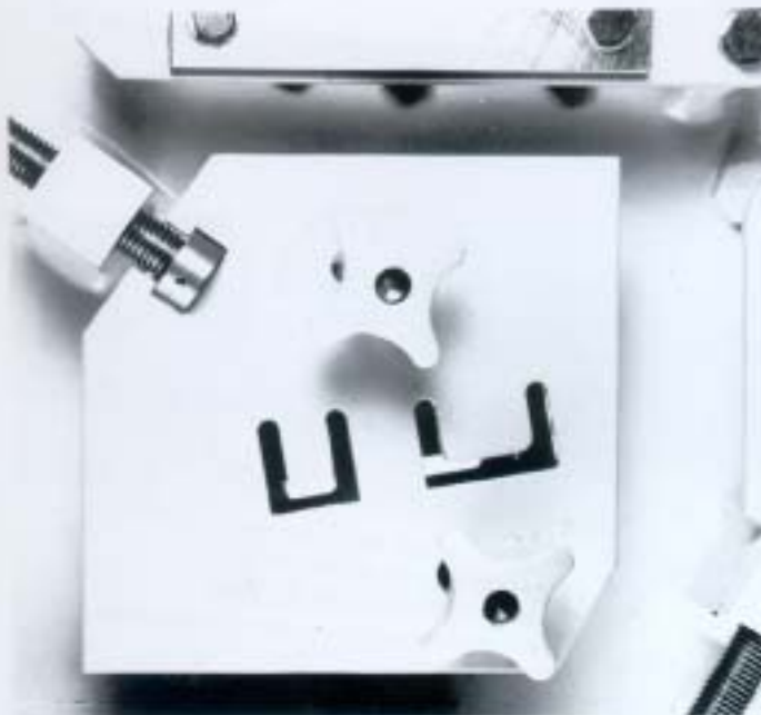
Corte de perfil U, pequeñas dimensiones. HYDRACROP. Small U-profiles cutting equipment. HYDRACROP. Cisallage de profilés en U, petites dimensions. HYDRACROP. Profilstahlmesser mit Niederhalter zum Schneiden von U-Profilen mit kleinen Abmessungen, HYDRACROP.
