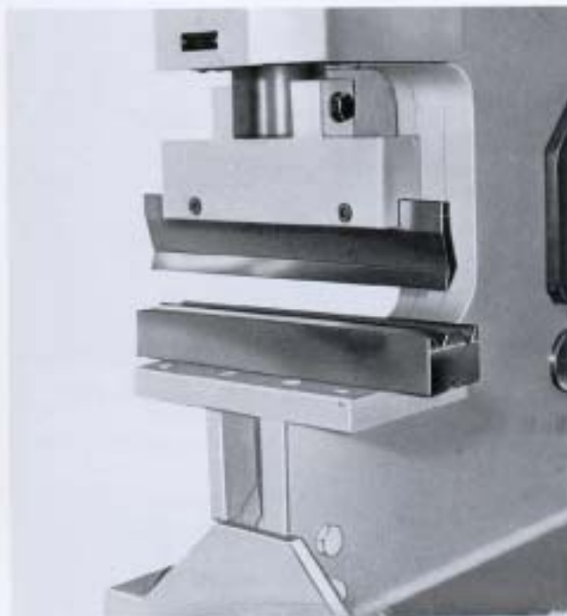
Equipo de plegadora en cizallas hidráulicas. Bending equipment HYDRACROP. Équipement de pleuse sur cisailles hydrauliques. Abkanteneinrichtung
