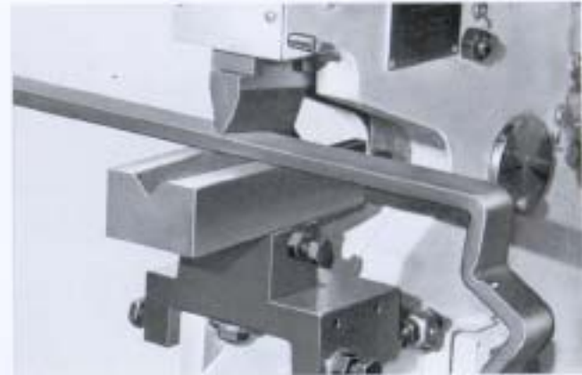
Utiles de plegado en la MINICROP. Bending tooling on the MINICROP. Outillage de pliage sur la MINICROP. Abkanteneinrichtung MINICROP
