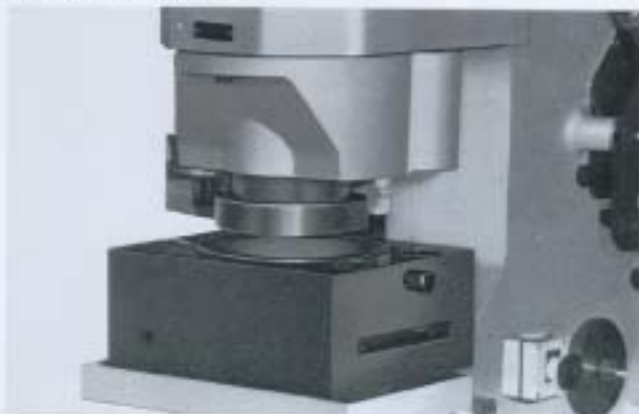
Equipo de punzonado especial Ø 160. Special punching equipment Ø 160. Equipement de poinçonnage spécial Ø 160. Stanzen von übergroßen Löchern bis 160 mm. Durchmesser.
