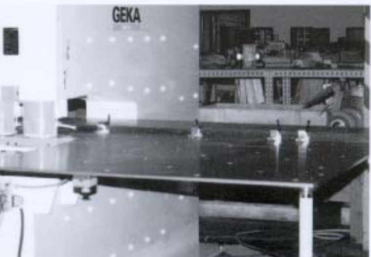
Poinonneuse  deux ttes avec table multistop especial. Lochstanz mit zwei Stanzzylindern und Sonder-Mehrtachenschlag-Tisch.
