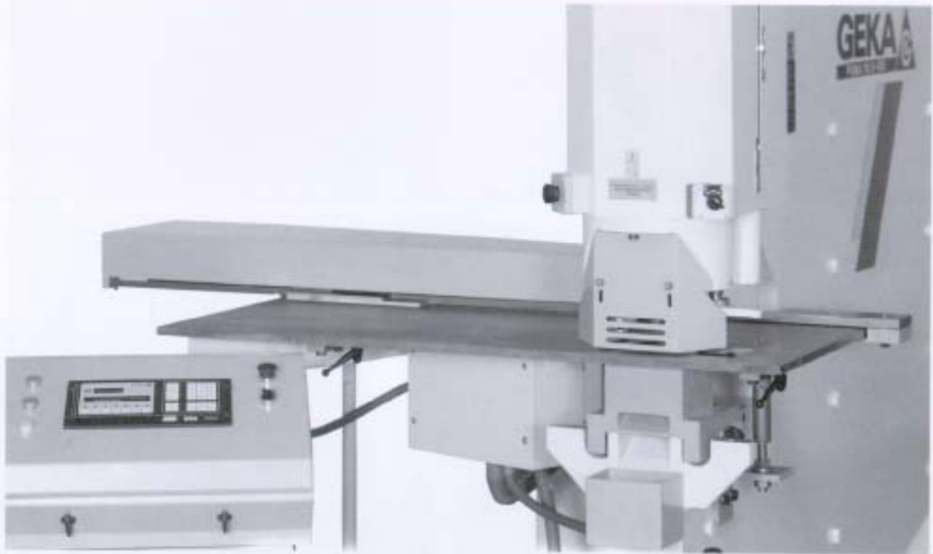
Mesa posicionamiento de topes. Gauge table.
