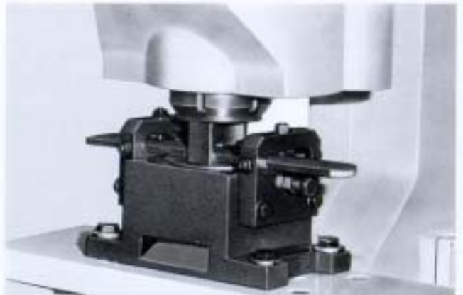
Equipo para el redondeado de extremos de flauta en HYDRACROP. Bar end radiusing equipment fitted to HYDRACROP. Équipement pour l'arrondissement d'extrémités de fer plats sur HYDRACROP. Abrundeneinrichtung für Flachstahl, HYDRACROP.
