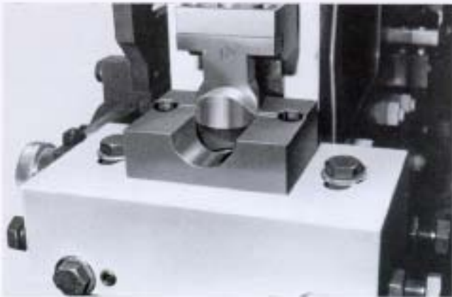
Entallado de tubos (para empalme de tubos). Tube notching (for joining tubes). Grugeage de tube (jusure de loup). Rohrauskinkeneinrichtung für Rohre bis 2 Zoll
