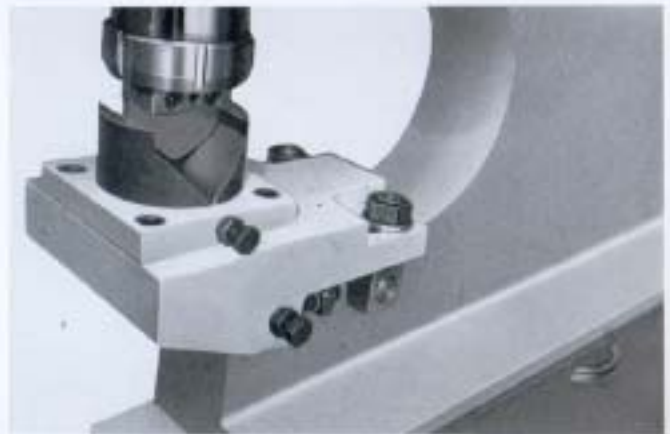
Corte de L en el punzonado. Angle cutting in punching station. Coupe de L. Winkelschneideinrichtung f  r Lochstanzen.
