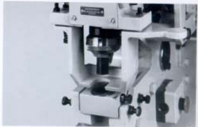
Punzonado diámetros mayores. MICROCROP-36. Large diameter punching. MICROCROP-36. Poinçonnage de grands diamètres. MICROCROP-36. Stanzen von grossen Durchmessern. MICROCROP-36.
