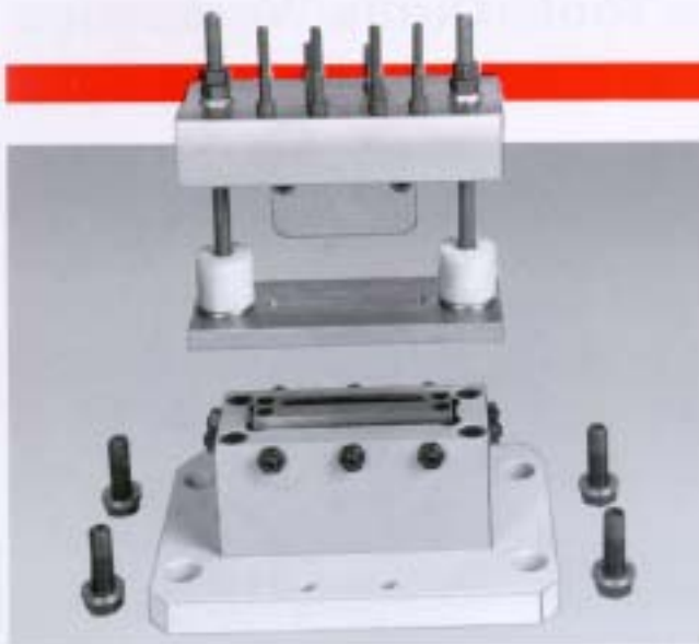
Equipo para fabricación de rejillas. Equipment for the making of gratings.
